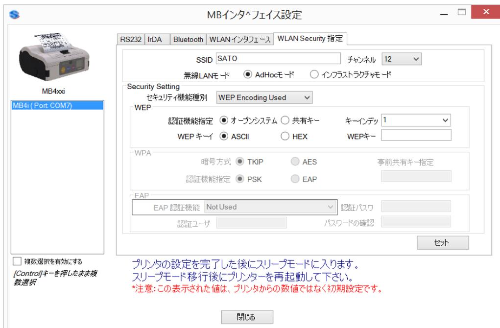
Figure 50 ネットワークインターフェースカードの設定
