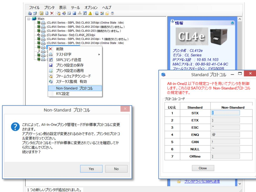
Figure 67 標準ならびに標準外プロトコル
